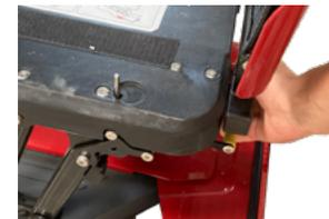
Sollevare la barra di piegatura con una mano e sostenere il sedile con l'altra mano, abbassando lentamente il sedile.
