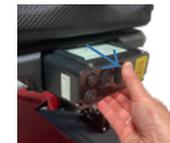
Abbassare il pulsante per staccare la batteria e rimuoverla delicatamente.
