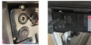
2 Collegare il caricabatterie direttamente alla porta di ricarica sulla batteria situata sotto il sedile
