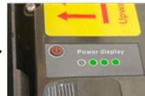
Quando la ricarica è completa, vengono visualizzati i LED verdi
