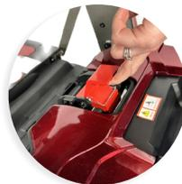
2 - Rimuovere il blocco motore con una mano. Con l'altra, rimuovere il telaio fino a quando le barre guida (rosse) toccano il pavimento.
