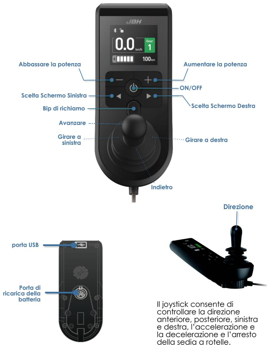
Il joystick consente di controllare la direzione anteriore, posteriore, sinistra e destra, l'accelerazione e la decelerazione e l'arresto della sedia a rotelle.
