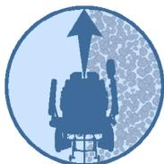
**Senza la tecnologia Ergo Drive**, il motore della ruota situata sulla superficie con maggiore aderenza distribuirà meno velocità dell'altro. Le 2 ruote Gli autoveicoli quindi non avanzeranno alla stessa velocità. Questo fenomeno porterà, oltre a un sentimento guida scarsamente padroneggiata, una modifica della direzione della sedia.
