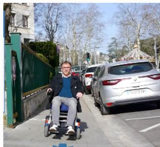
**Come funziona ?** Il nuovo modulo di potenza, dotato di La tecnologia Ergo Drive interpreta la velocità di ciascuna ruota e la analizza in tempo reale se conforme alle informazioni fornite dall'utente tramite il manipolatore. Se la velocità della ruota non è corretta (perché ad esempio su una superficie accattivante), quindi il modulo la potenza lo modificherà in base alle informazioni provenienti dal joystick.
