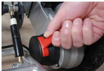
**Per azionare, i motori devono essere innestati e le leve rosse sul retro dei servomotori, sollevate.** La sedia funzionerà poi elettricamente ma non può essere spinto da a terzo.
