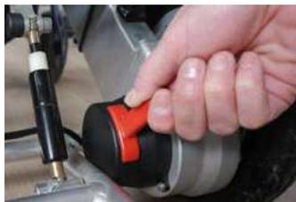
**Per azionare, i motori devono essere innestati e le leve rosso sul retro dei servomotori, sollevate.** La sedia funzionerà poi elettricamente ma non può essere spinto da a terzo.
